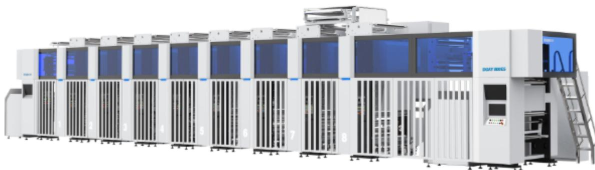
传统的印刷机已不再适应时代的发展。为了适应某些需求，我们需要凹版印刷机。但是在使用凹版印刷机之前，我们必须对此有一定的了解。因此，接下来，我们将向您介绍什么是凹版印刷机以及凹版印刷机的分类。凹版印刷机印刷时，以刮墨刀将版面上空白部分的油墨刮清，留下图文部分的油墨，然后过纸，由压印滚筒在纸的背面压印，使凹下部分的油墨直接转移到纸面上，经收纸部分将印刷品堆集或复卷好。根据制版方法，将其分为两类：雕刻凹版和腐蚀凹版。（1）机械雕刻的凹版机械雕刻的凹版是通过在印版滚筒表面上使用机械控制的雕刻刀制造的，从而减少了手工雕刻的重复和繁琐的工作。制版速度更快，周期更短，制版成本也更低。（2）手工雕刻
