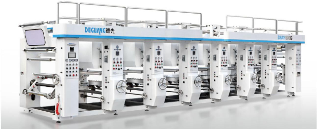
传统的印刷机已不再适应时代的发展。为了适应某些需求，我们需要凹版印刷机。但是在使用凹版印刷机之前，我们必须对此有一定的了解。因此，接下来，我们将向您介绍什么是凹版印刷机以及凹版印刷机的分类。凹版印刷机印刷时，以刮墨刀将版面上空白部分的油墨刮清，留下图文部分的油墨，然后过纸，由压印滚筒在纸的背面压印，使凹下部分的油墨直接转移到纸面上，经收纸部分将印刷品堆集或复卷好。根据制版方法，将其分为两类：雕刻凹版和腐蚀凹版。机械雕刻的凹版机械雕刻的凹版是通过在印版滚筒表面上使用机械控制的雕刻刀制造的，从而减少了手工雕刻的重复和繁琐的工作。制版速度更快，周期更短，制版成本也更低。手工雕刻手工雕刻是由技术人员使用刻刀根据原始图形在印版滚筒的表面上制成的。印版材料可以由铜或钢板制成。体力劳动繁琐，制版成本较大，周期较长。但是，制作的凹版印刷品线条清晰，印刷品具有强烈的层次感，很难被他人伪造。主要用于生产用于证券和高质量艺术品的印刷凹版印版。电子雕刻凹版这种版本主要是通过电子控制装置控制雕刻刀的方式在印版滚筒的表面上雕刻的。使用电子雕刻机，根据光电原理，控制雕刻刀以雕刻出鼓表面上的单元。
